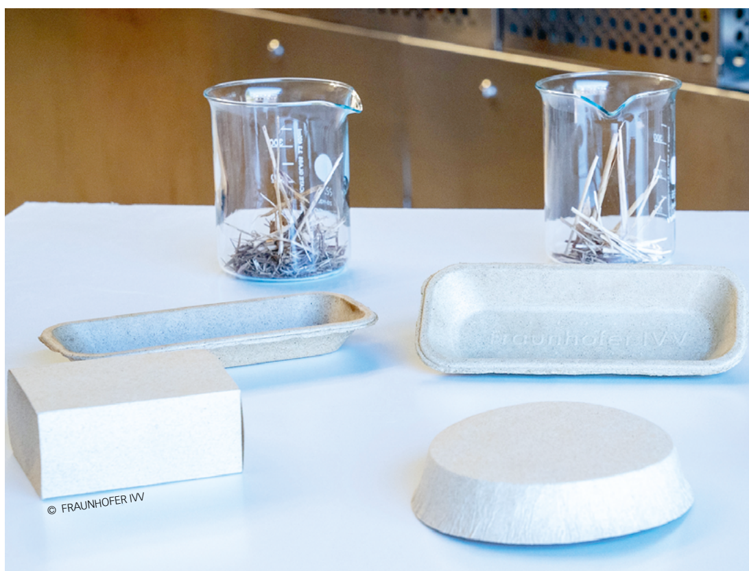
Nachhaltige, im Faserguss- und Tiefziehverfahren hergestellte Packmittel aus Moorpflanzen
